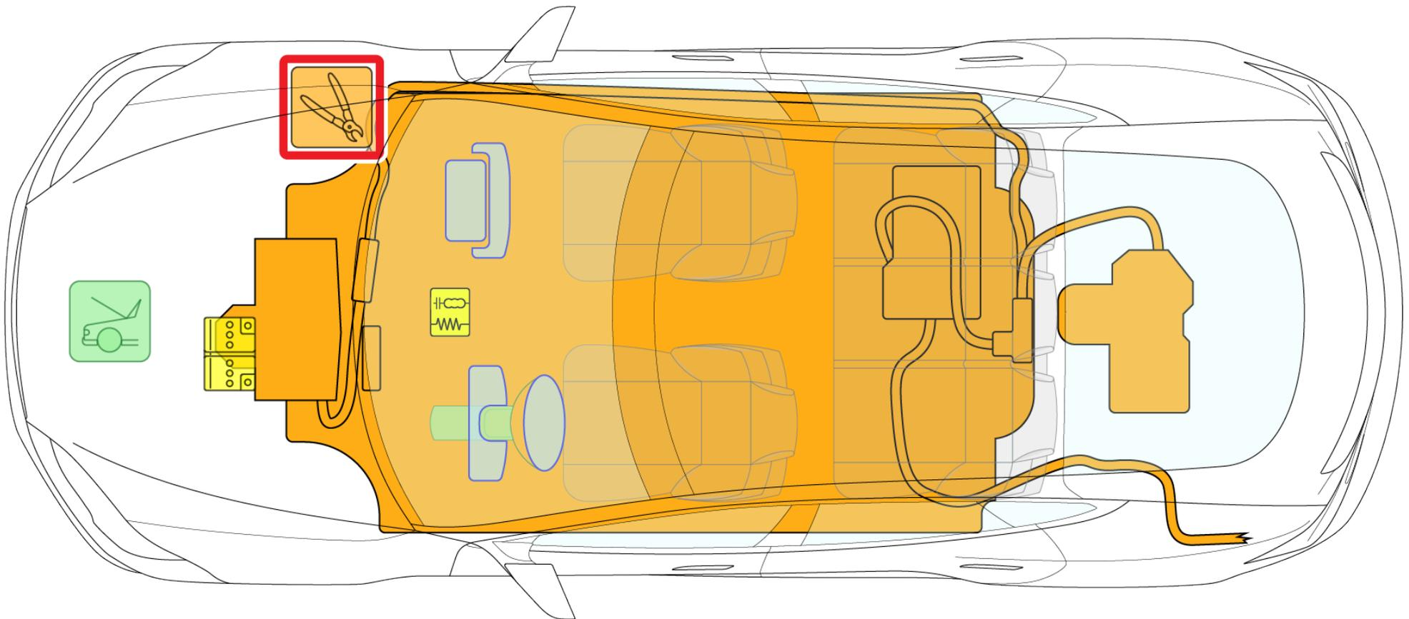
**⚠ Warnung:** Gehen Sie unabhängig vom verwendeten Deaktivierungsverfahren **STETS DAVON AUS, DASS ALLE HOCHVOLT-KOMPONENTEN UNTER STROM STEHEN!** Das Durchtrennen, Drücken und Berühren von Hochvolt-Komponenten kann schwere oder sogar tödliche Verletzungen nach sich ziehen.
