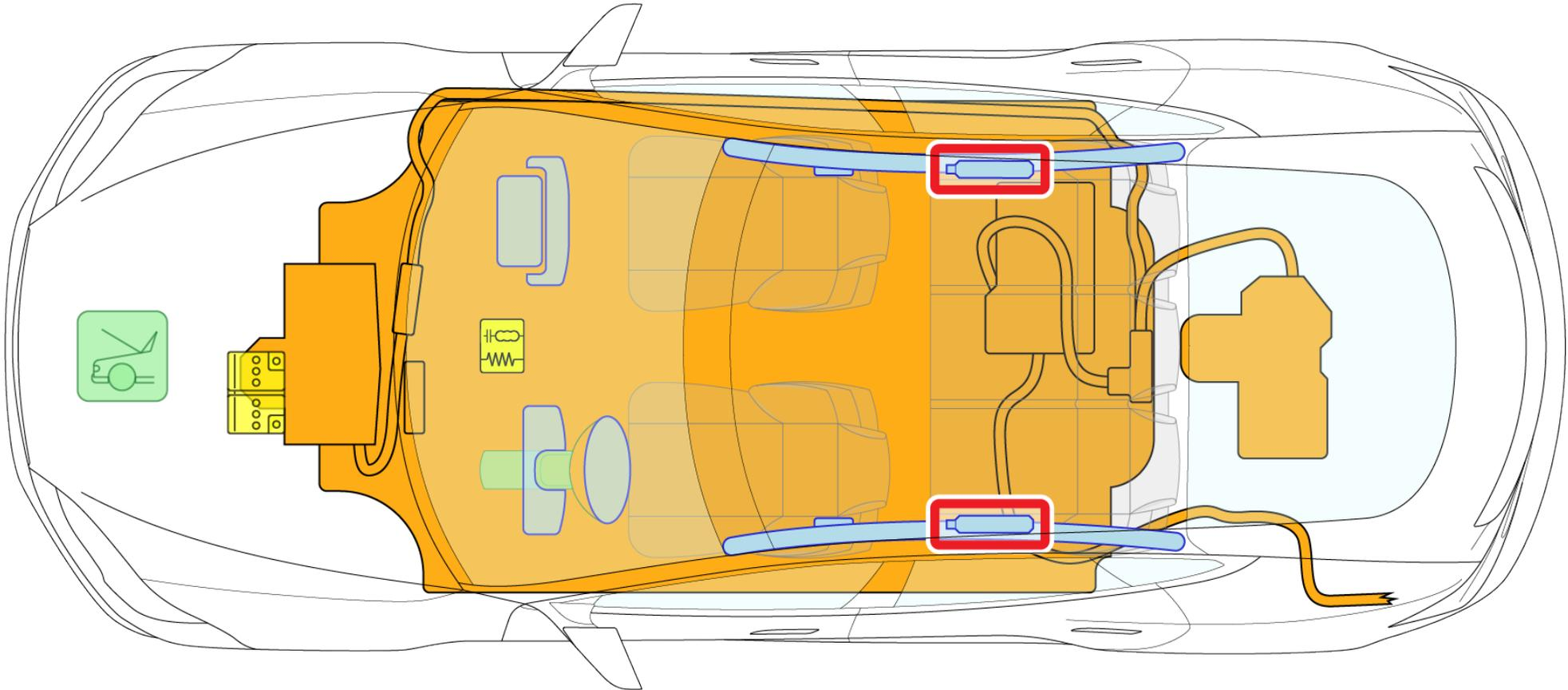
**⚠ Warnung:** Die SRS-Steuereinheit verfügt über eine Ersatzstromversorgung mit einer Entladezeit von ca. zehn Sekunden. Berühren Sie die SRS-Steuereinheit erst 10 Sekunden nachdem ein Airbag oder Gurtstraffer ausgelöst wurde.
