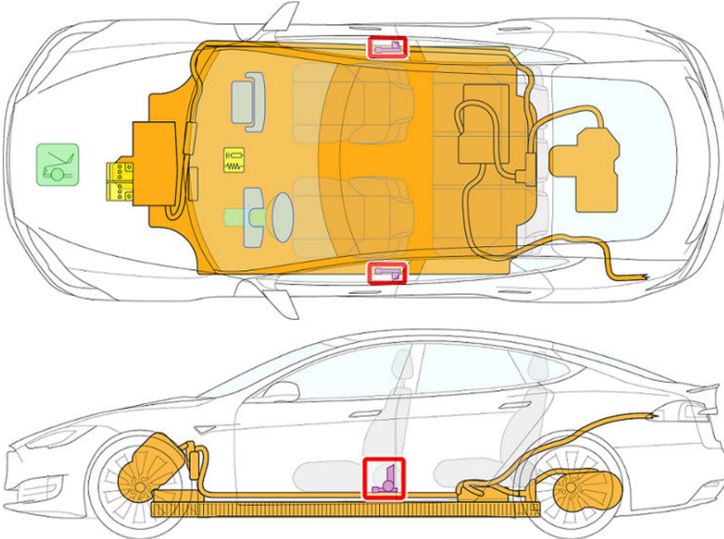
**⚠ Warnung:** Die SRS-Stuereinheit verfügt über eine Ersatzstromversorgung mit einer Entladezeit von ca. zehn Sekunden. Berühren Sie die SRS-Stuereinheit erst 10 Sekunden nachdem ein Airbag oder Gurtstraffer ausgelöst wurde.
